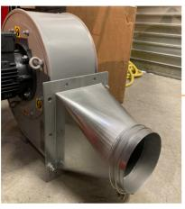
PIÈCE DE TRANSFORMATION Réalisation d'une pièce de transformation carré / ronde au refoulement
